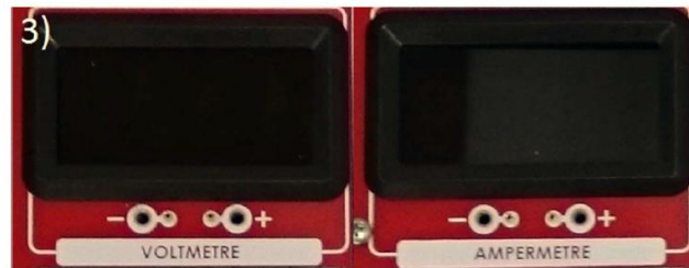
Şekil 1.8 Voltmetre ve Ampermetre
